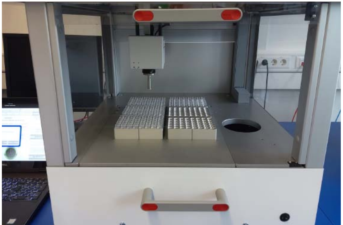
Mit dem „SampliTAG“-Tube Labeler von Samplision kann die Kennzeichnung von Vials automatisiert werden. Bild: Samplision
